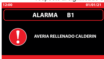
Ejemplo de ventana de alarma.
